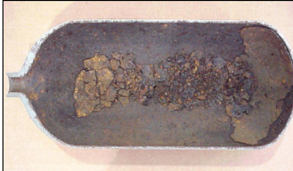
Totalkorrosion einer Tauchflasche
