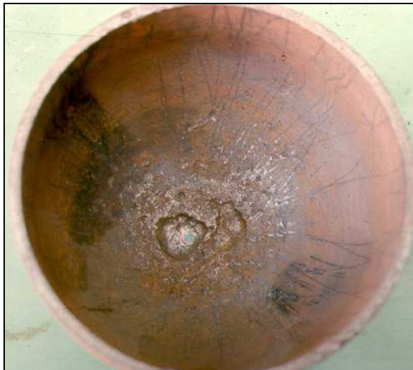
Lochfrass im Boden einer Tauchflasche
